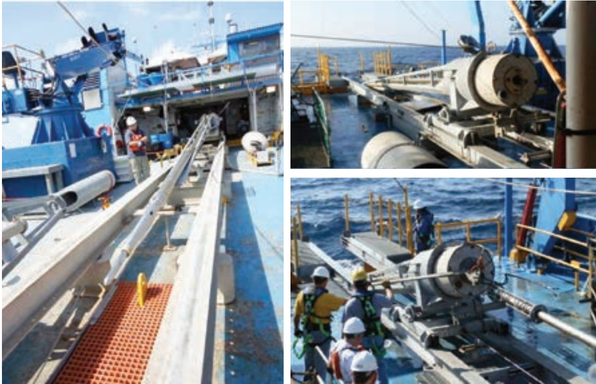
Figura 1. Stinger CPT listo para la implementación (izquierda); desplegado sobre la popa de la embarcación (derecha).
