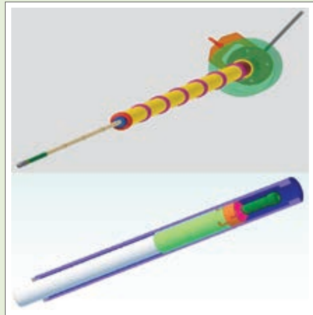
Figura 4. Ilustración esquemática del muestreador Stinger. Arriba: ensamble general; abajo: detalle del muestreador.
